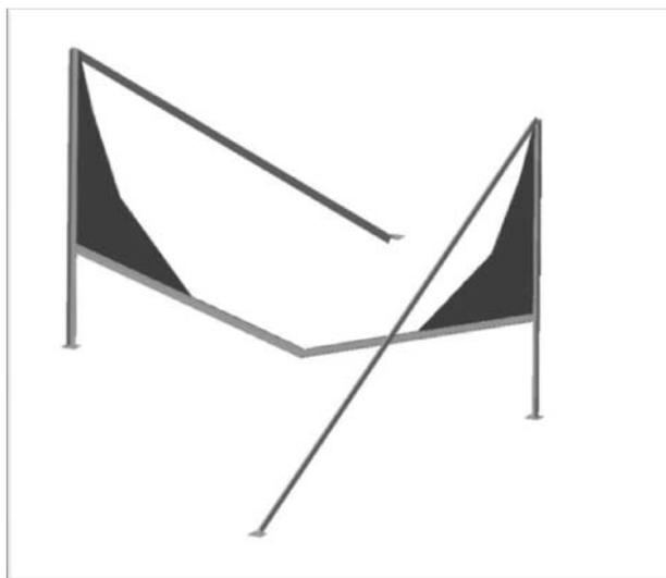
Подкладываем под опоры центральной рамки, заранее заготовленные подкладки из металла или твердого дерева. Выравниваем рамку по линии КВЛ и аккуратно закрепляем ее откосными стойками или уголками. Аналогично выставляем оставшиеся рамки, но теперь уже их можно скрепить между собой.
