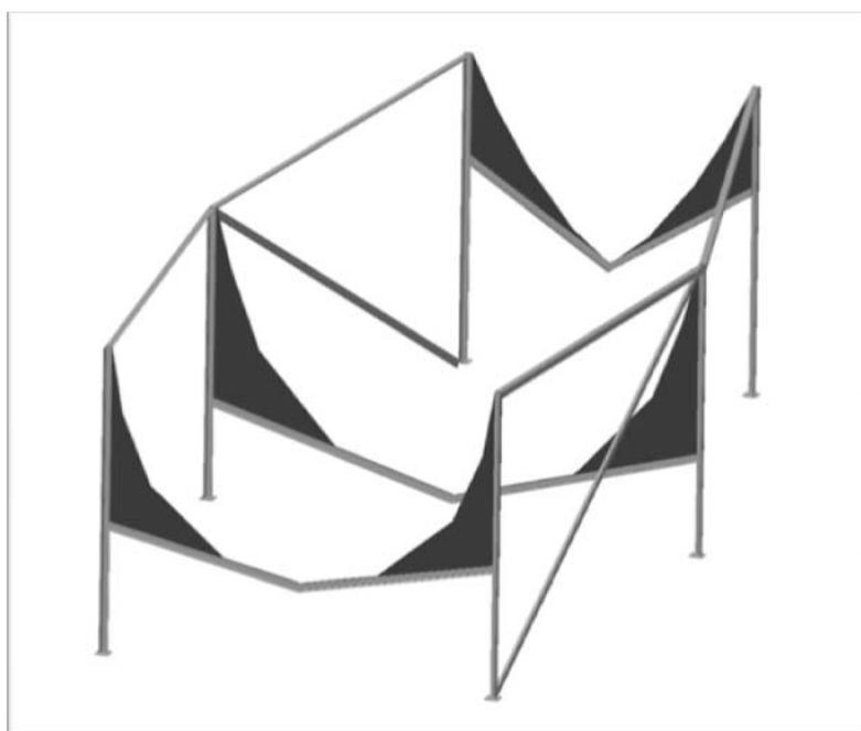
После монтажа всех рамок еще раз проверьте размеры и уровни. В случае отклонения – нужно подкорректировать и затем окончательно заварить. Следите за размерами и в процессе работы – это залог успешного выполнения проекта.
